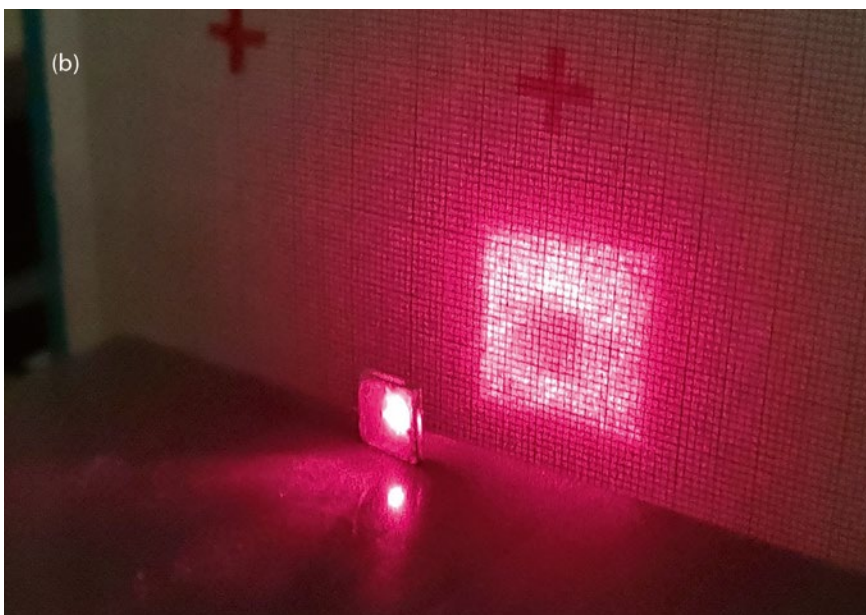
Bild 2 Aufweitung des Laserstrahls durch Multilense-Array aus Glas (a) und Multilense-Array aus transparentem ZrO_2 (b) (© FGK)
