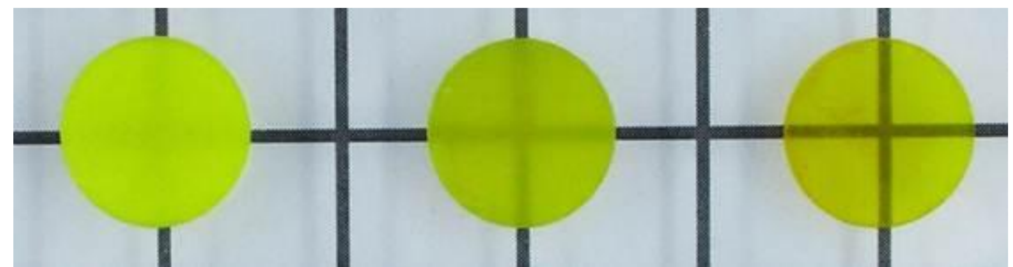
Gezielt eingestellte Transparenz von Ce 3+ :YAG-Keramiken (LED-Konverter).
