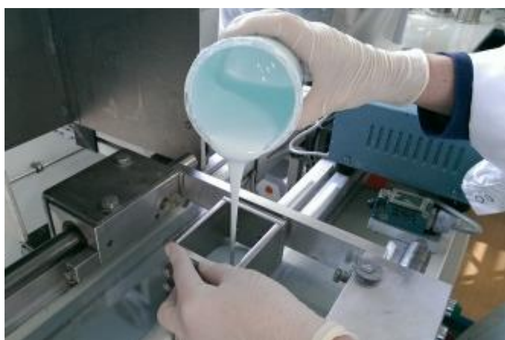
Formgebung mittels Foliengießen.
