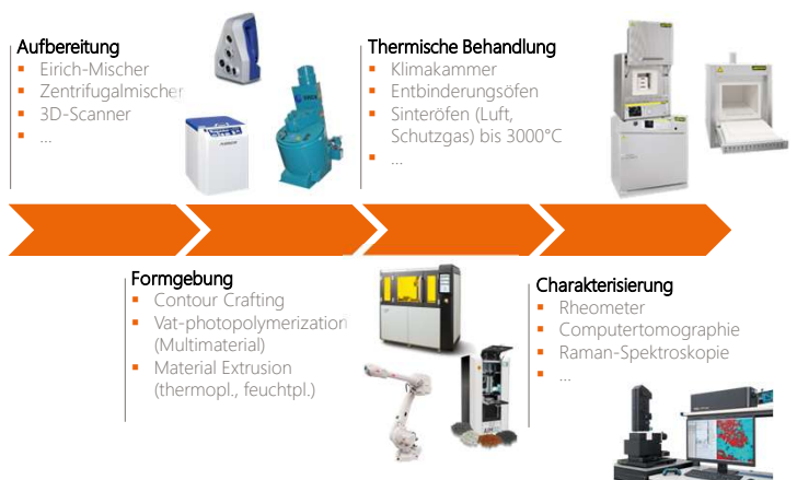
Die Prozesskette und Anlagen des 3DKeramik
